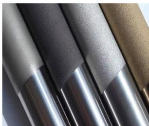
Тонкослойное покрытие «ФЛУОРА-ДС» (ЭПИЛАМ®Флуора) предназначено для обработки (покрытия, пропитки) лакокрасочных покрытий (ЛКП, после их высыхания на поверхности), металлопорошков, металлопокрытий, полимерных, текстильных и спецпокрытий для защиты:
